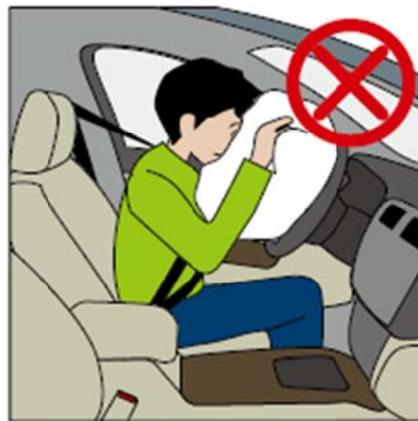
При управлении автомобилем верхняя часть тела не должна чрезмерно склоняться к рулевому колесу, в противном случае при срабатывании SRS это может привести к получению повреждений верхней части тела.
