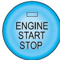
Когда положение передачи находится в положении «Р» и при этом нажата педаль тормоза, индикатор на кнопке пуска будет гореть зеленым цветом; если нажать кнопку запуска, то произойдет пуск двигателя.
